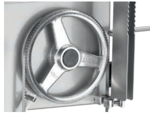
Pulegge superiori ermetiche Hermetic upper pulleys
